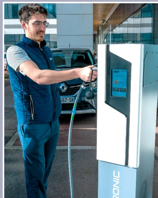
Un démonstrateur d'aVENir teste des bornes bidirectionnelles à l'Enedis Lab à Nanterre.
