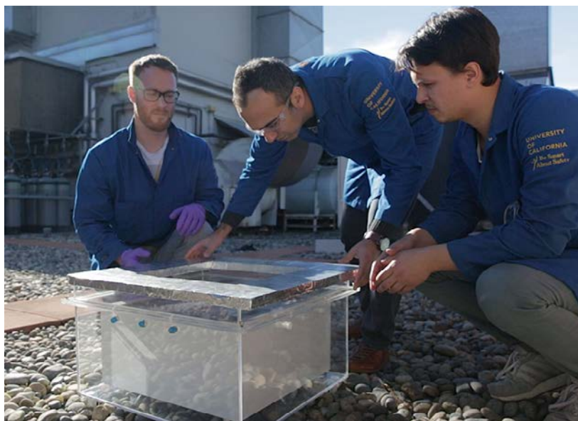
Les chercheurs préparent leur dispositif pour capter l'humidité de l'air. Il contient un composé poreux qui piège l'eau durant la nuit, puis libère le liquide dans la cuve fermée durant la journée.
