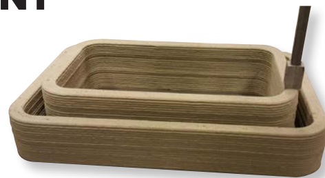
Cette structure, imprimée en 3D, est un empilement de couches successives. À quel moment ses parois risquent-elles de s'effondrer ? C'est l'objet de la modélisation réalisée.
